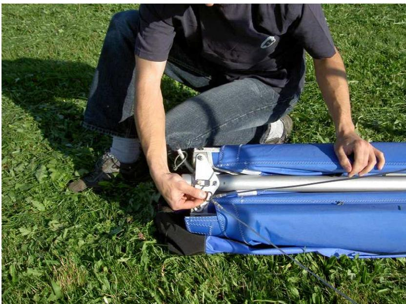
**Vorderverspannung an der Nase einhängen**
